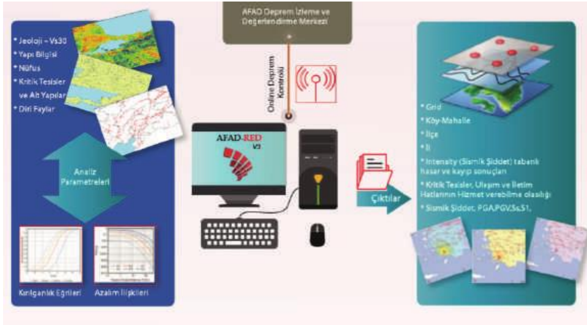
Şekil 2.7. AFAD-RED çalışma prensibi
